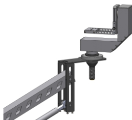
Позиция чаша на пластине крана вверх моторизированная голова вверх
